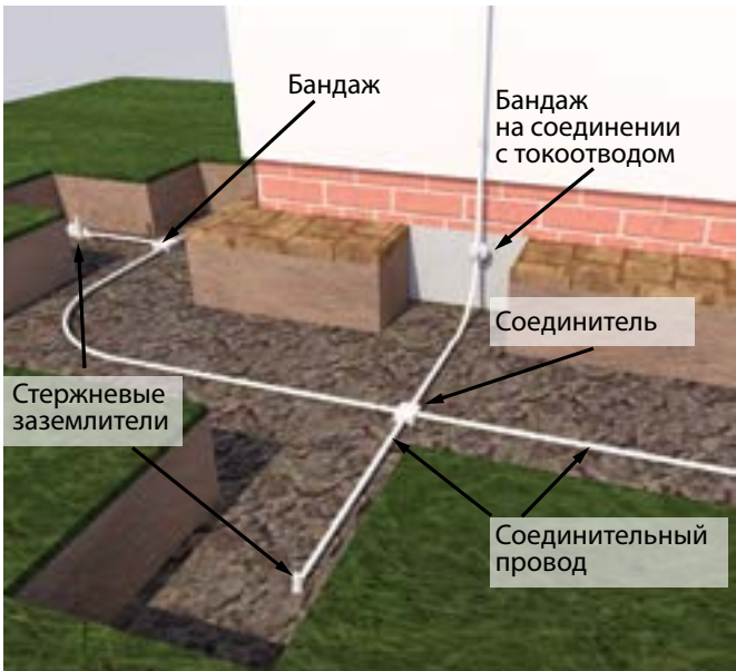
Рис. 2.9.3 - Глубинный заземлитель
