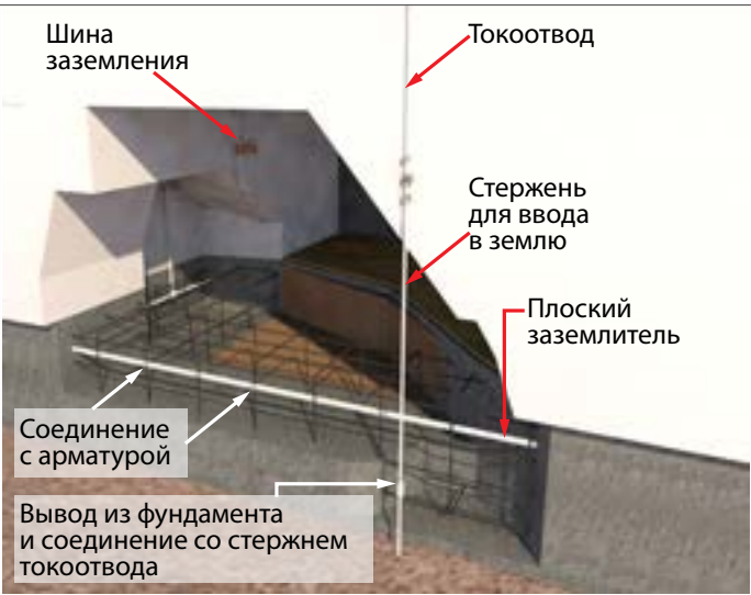
Рис. 2.9.6 – Фундаментный заземлитель типа В
