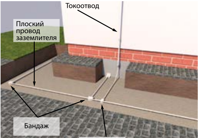
Рис. 2.9.5 – Кольцевой заземлитель типа В
