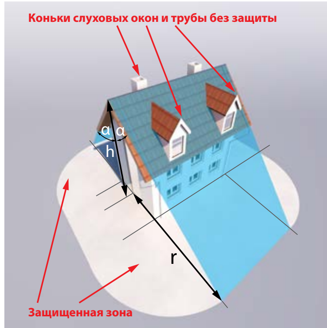
Рис. 2.3.5 - Зона защиты конькового молниеприемника
