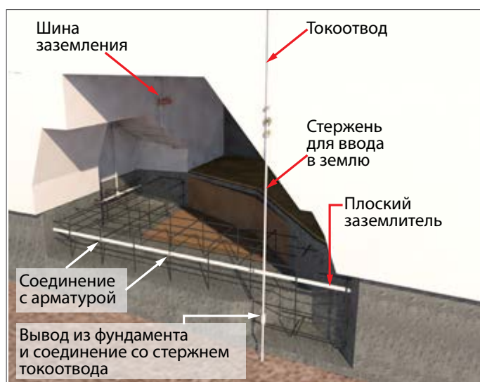
Рис. 2.10.6 – Фундаментный заземлитель типа В
